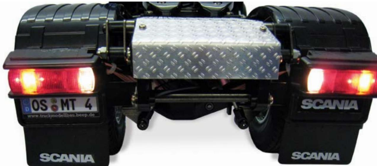
*Für Abblend- und Fernlicht wird je eine 5-Millimeter-LED benötigt, für die unterschiedliche Helligkeit sorgen verschiedene Vorwiderstände*
